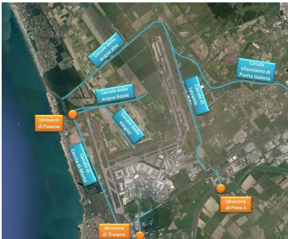
Schema delle dorsali principali di drenaggio
